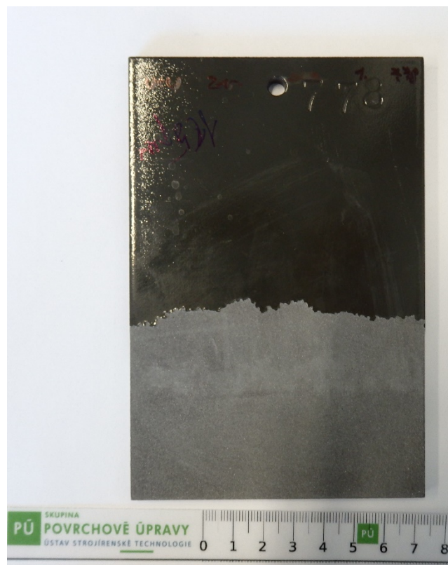
Obrázek 7: Dvouvrstvý nátěrový systém U2008+U2080(POLYURETAN)
